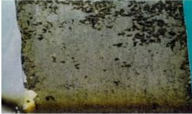
Figur 1: 0 ppm H 2 S med Nutriox® konseptet. Betongbiten oppvisar inga skador etter 42 månader
